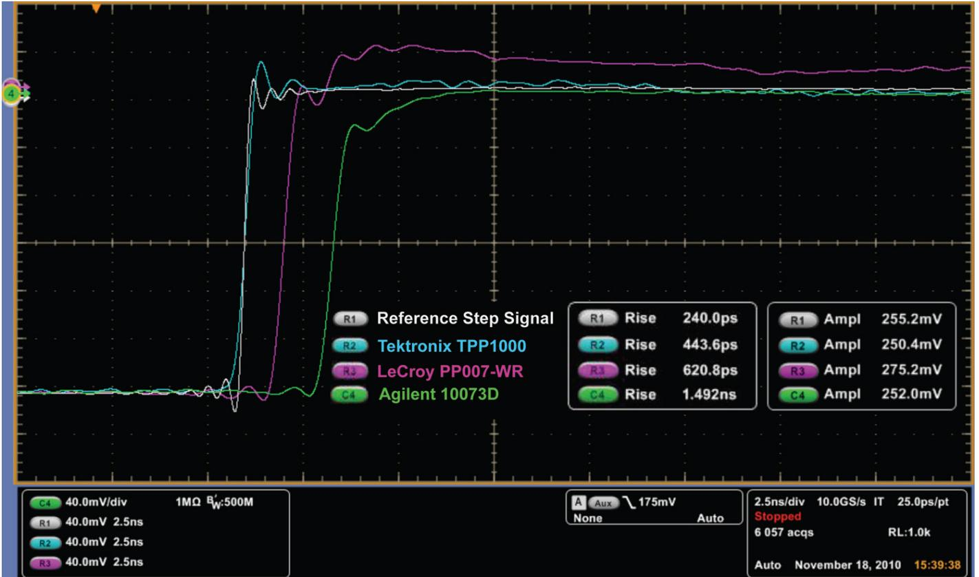
圖 1 太克、LeCroy 和安捷倫標準配備被動式電壓探棒的上升時間
