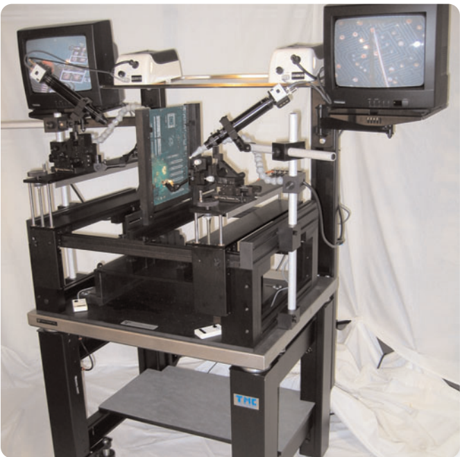
▶ 図 19. Probing Solutions, Inc 社製 2020H/V プロセス・ワーク・ステーション
