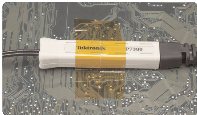
▶ 図 9. プローブ本体の 2 種類の固定方法
