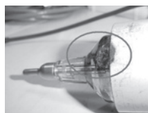
▲写真2 高い電圧による絶縁破壊の例
