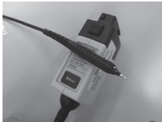
▲写真1 アクティブプローブ — グラウンドを基準としたシングルエンド信号を取り扱うプローブ。「FETプローブ」とも呼ばれる
