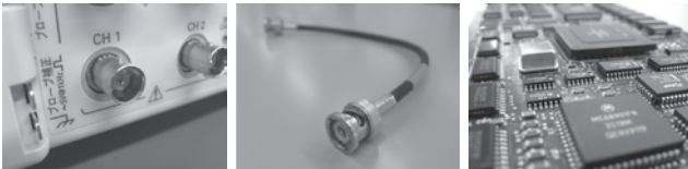
▲写真1 入力コネクタ ▲写真2 同軸ケーブル ▲写真3 測定点—ここどうやって接続するかが問題
