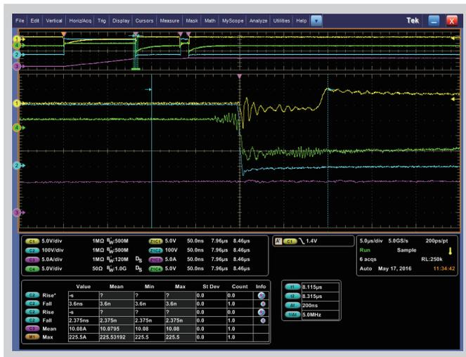
IsoVuによるハイサイドの電圧波形 (CH4: 緑の信号)
