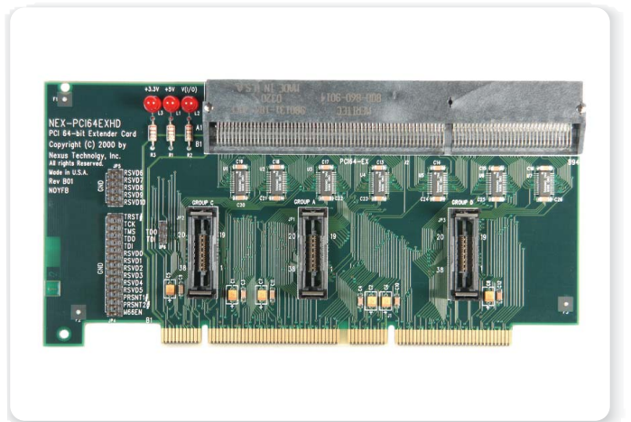
► 图9 – 逻辑分析仪探测使用的PCI内插夹具(图片由Nexus Technologies提供)
