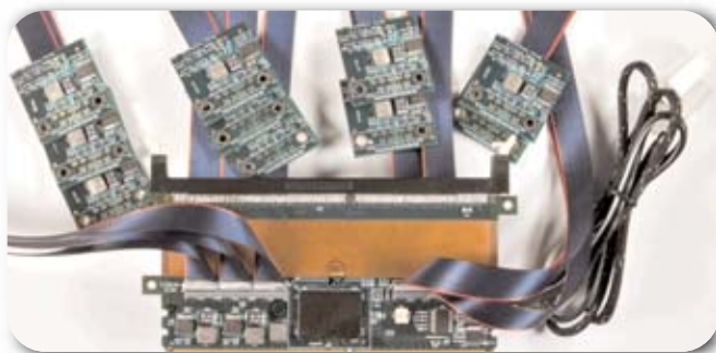
► 图8. NEX-FBD-LAI把AMB置于LAI模式，解析串行的北向/南向业务，为逻辑分析仪提供数据。(图片由Nexus Technology公司提供)
