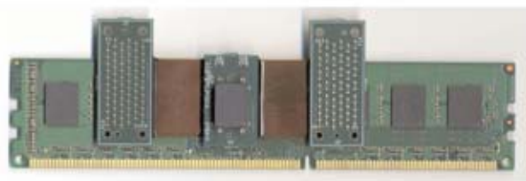
图 3. 安装在内存 IC 和 DIMM 之间芯片内插器
