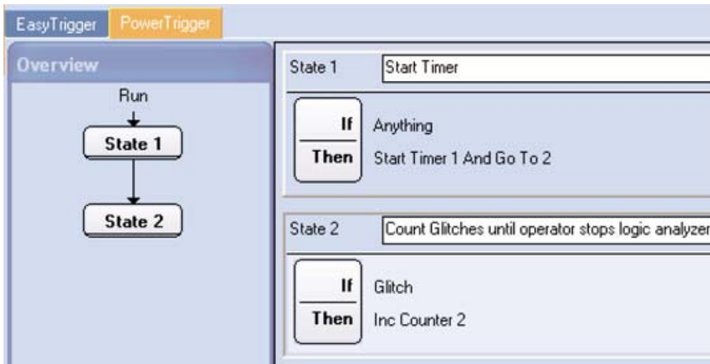
图 11. 使用逻辑分析仪 PowerTrigger 程序，确定逻辑分析仪运行的时间长度，计算 SDRAM 时钟毛刺数量。
