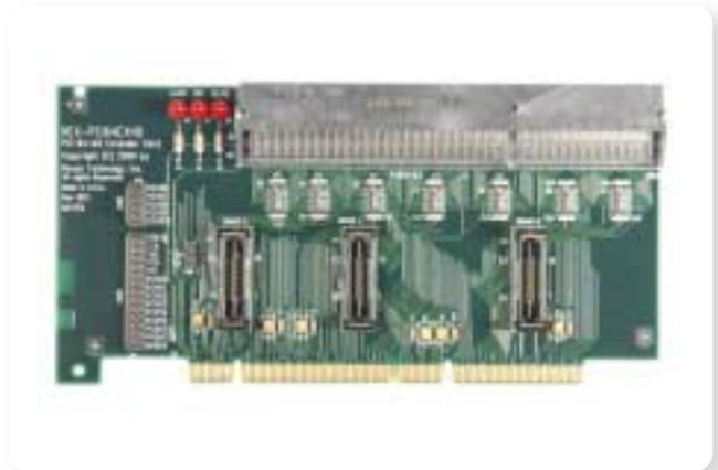
▶ 그림9 - 로직 애널리저 프로빙용 PCI 인터포저(사진 제공: Nexus Technologies)
