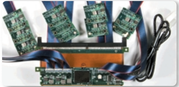
▶ 図8：NEX-FBD-LAIにはAMBが搭載されており、LAIモードでノースバウンドとサウスバウンドのトラフィックを平行化し、データをロジック・アナライザに送出します（画像はNexus Technology, Inc.提供）。
