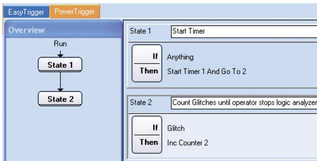
図8. ロジック・アナライザのPower Triggerプログラムを使用して、ロジック・アナライザの動作時間長とSDRAMのクロックのグリッチ数を計測する。
