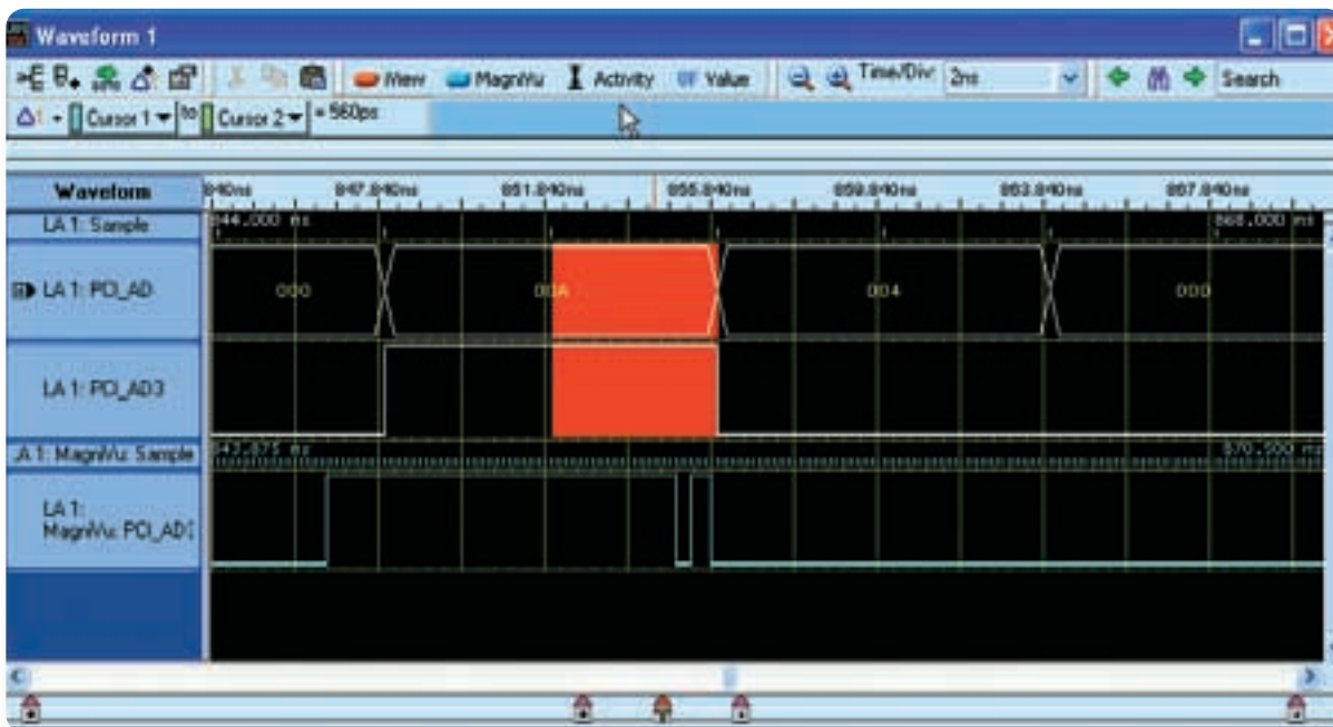
▶ 図22：ロジック・アナライザのMagniVu®アキュイジションにより、PCI_AD3信号のエラーが観測できます。
