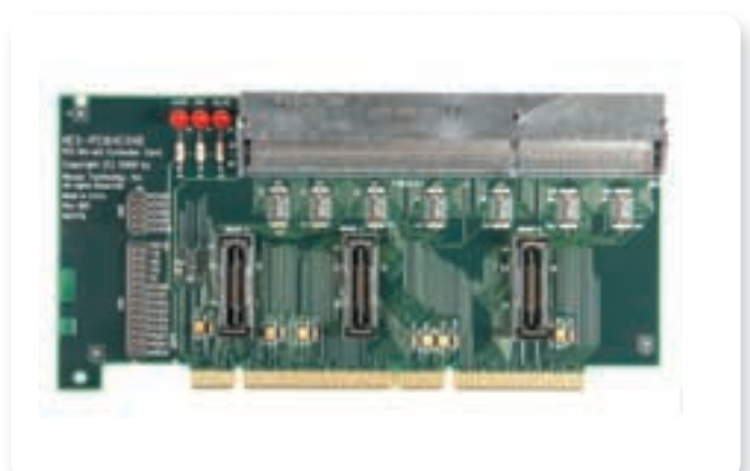
▶ 図9：ロジック・アナライザ・プロービング用PCIインターポーザ (写真提供：Nexus Technologies社)
