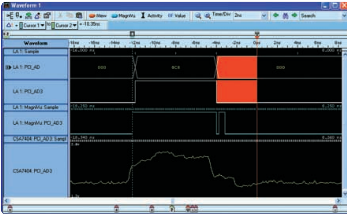
▶ 図23: iView機能により、PCI_AD3に潜むデジタル・エラーのアナログ特性が観測できます。
