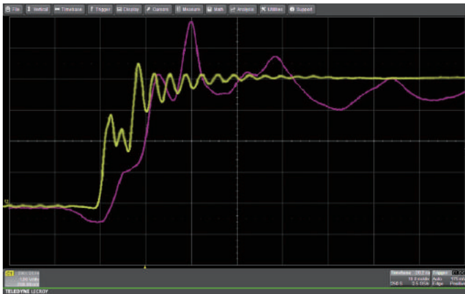
圖 6. LeCroy 示波器與 IsoVu 波形上的波形疊加比較。
