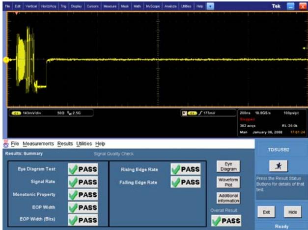
图 1.2. 高速操作中基本的 5 米 USB 电缆的波形和信号质量报告。
