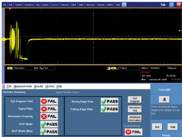
图 1.4. 高速操作中延长的 10 米 USB 电缆的波形和信号质量报告。
