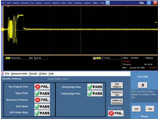
图 1.6. 高速操作中延长的7.5米USB电缆的波形和信号质量报告。
