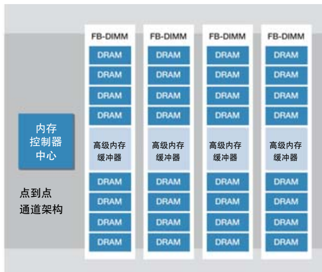
图 6. FB-DIMM 缓冲 FB-DIMM 上的 DDR2 SDRAM 信号。
