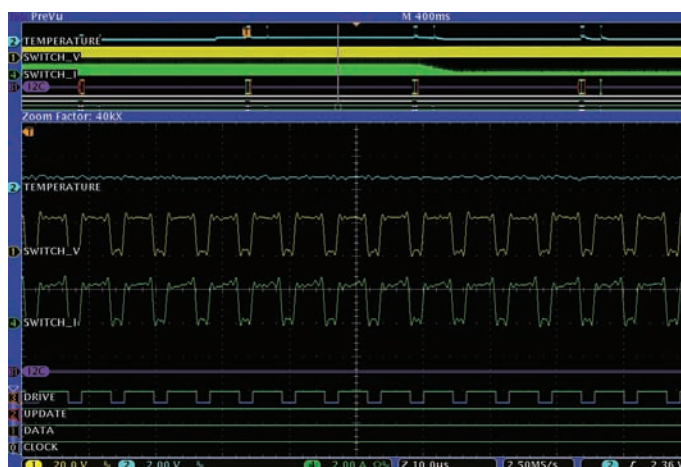
図1.6. ロング・メモリにより、スイッチング電源の充電制御における波形が拡大され、電圧波形と電流波形が詳細に表示されています。
