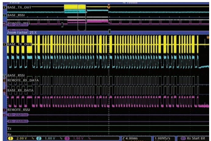
図2.4. 基地局トランシーバの送信波形とリモート・トランシーバの受信信号
