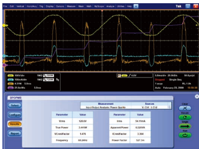
図14. DPOPWRによる電源品質測定の結果
