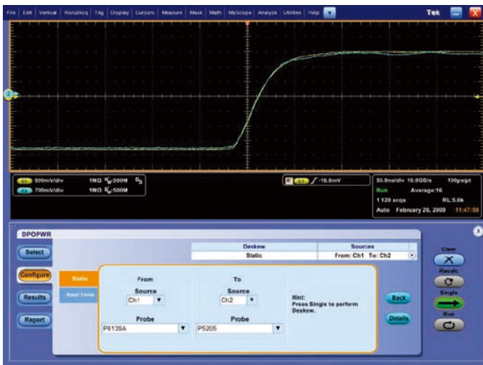
図2. 2本のプローブ間の静的スキュー補正後の様子
