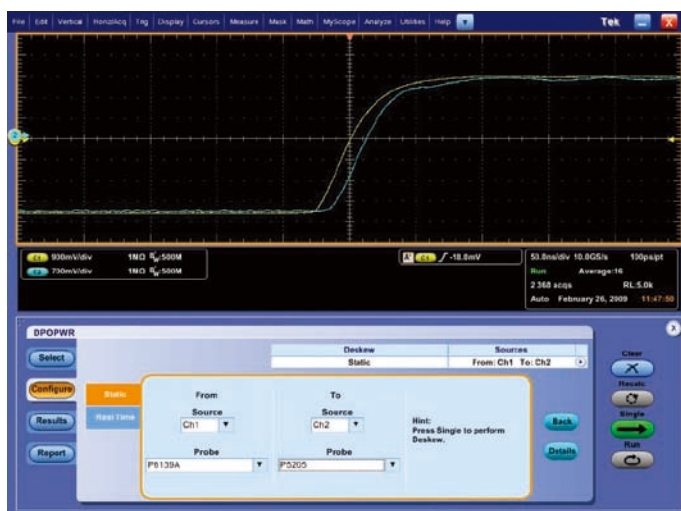
図1. 2本のプローブ間の静的スキュー補正前の様子
