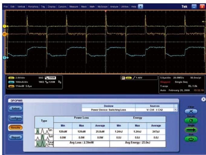
図8. DPOWPRによるスイッチング損失測定
