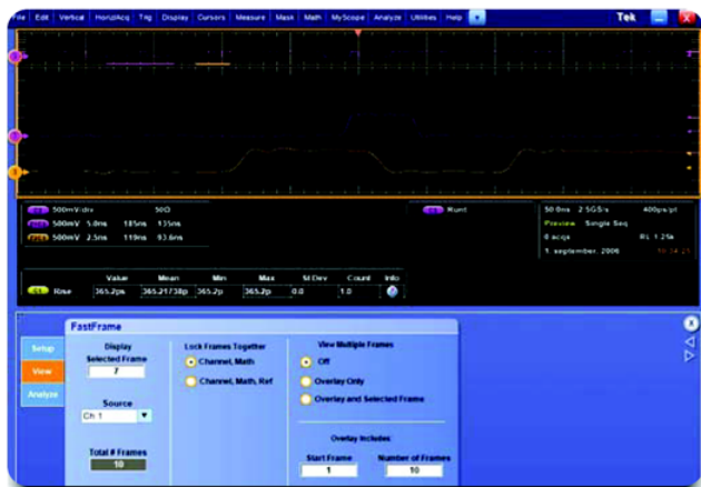
► 图 14. 在 FastFrame 采集中使用缩放功能比较间歇性异常事件。注意选定帧使用的 Multi-zoom 显示，在通道 3 上比较欠幅脉冲。
