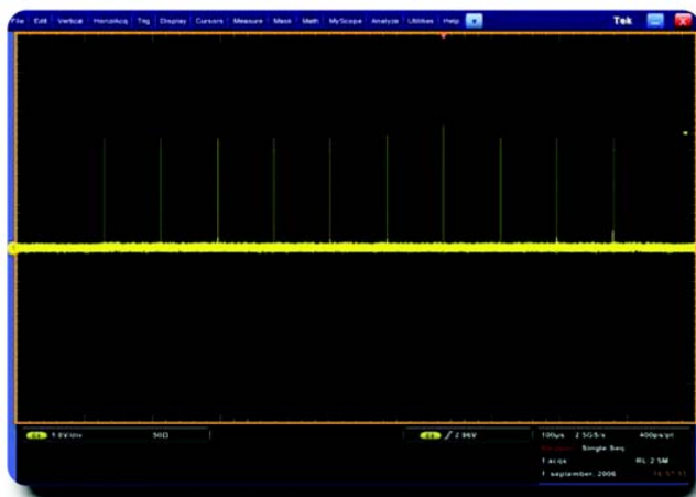
► 图 2. 在长记录长度时以高分辨率捕获的多个脉冲。
