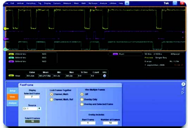
► 图13. 使用FastFrame的VIEW菜单滚动浏览采集数据，单独比较每次采集的条件。
