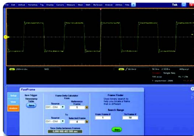
► 图11. FastFrame Time Stamp Snapshot 画面显示微处理器中断之间的相对时间。
