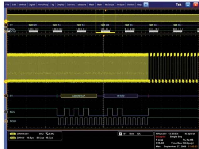
图 2: MSO70000 可以提供模拟和数字信号的相关观测
