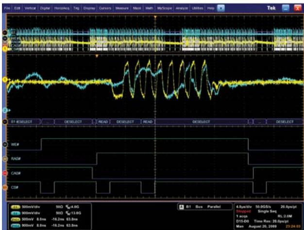
图 4: 内存读取周期的总线判定触发
