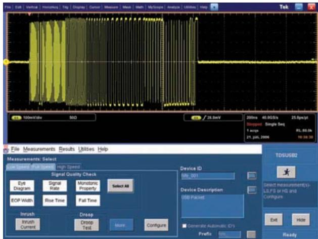
图1：TDSUSB2 高速一致性测试软件
