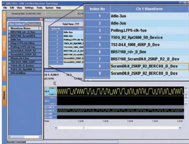
图 20: AWG 的序列发生器产生的链路训练码型、BERT 有序集和带抖动的码型
