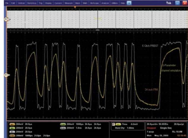
图 12：24 英寸走线的硬件通道及其软件仿真
