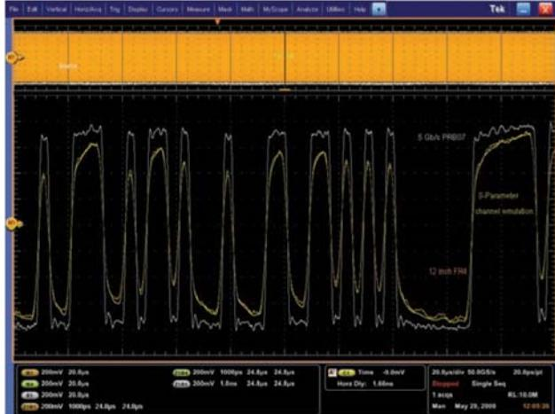
图 11：12 英寸走线的硬件通道及其软件仿真
