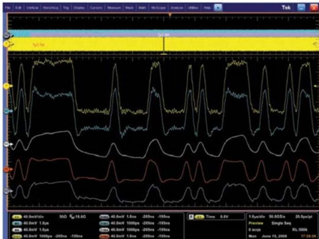
图 16: 5Gbps 原始信号(黄色)、去加重后波形(蓝色)、通过电缆波形(白色)、进行 CTLE 后的波形(红色)和经过 3 级 DFE 自适应算法后的波形(灰色)
