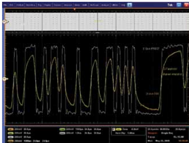
图 12. 24 英寸轨迹的硬件通道仿真和软件仿真。
