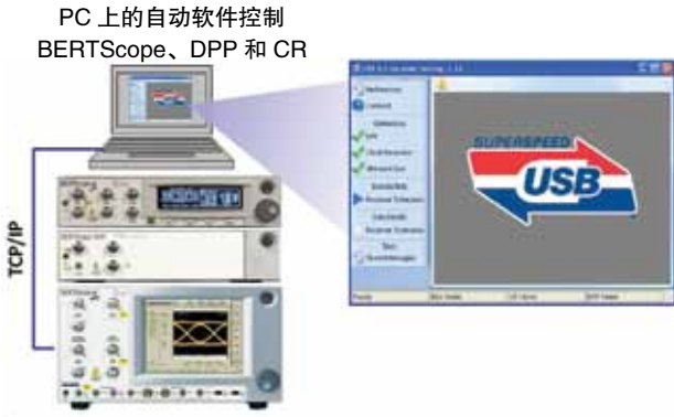
图 20. USB 3.1 接收机测试设置。
