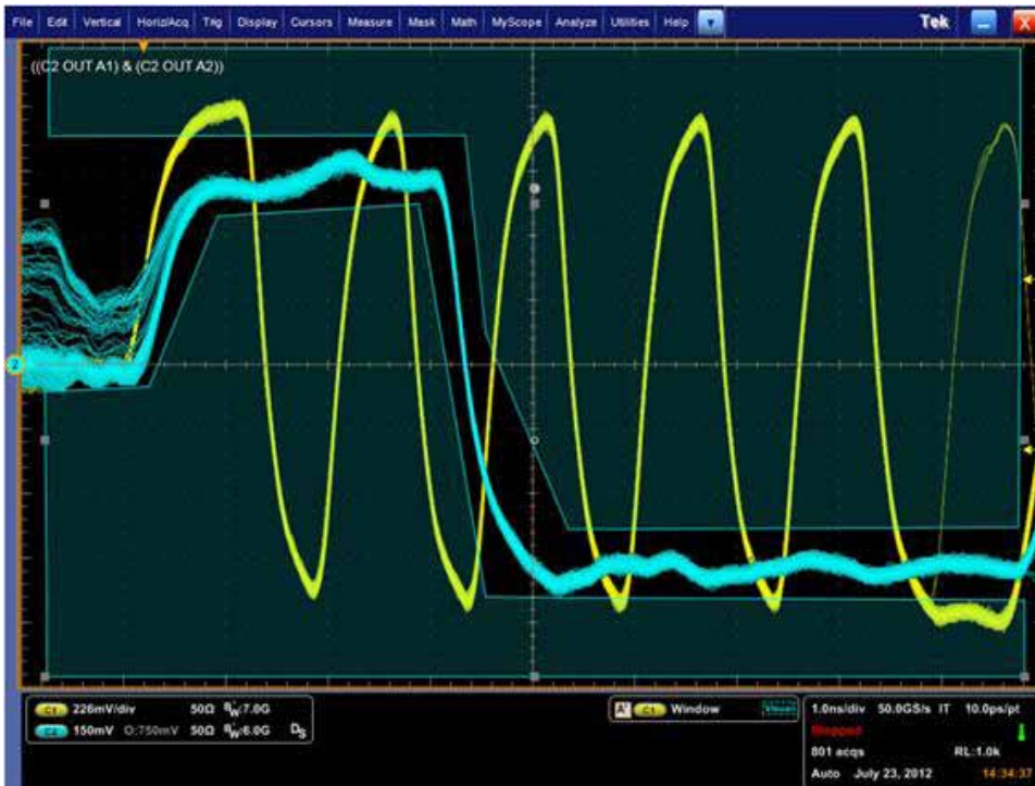
图 7. 触发数据码型 '11000000'。
