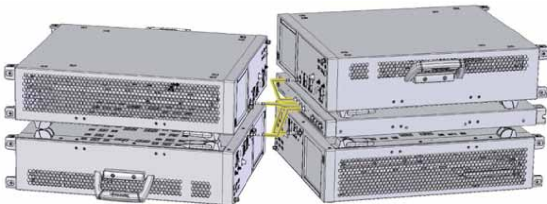
图 7：在 400G 相干光调制应用中，两台 DPO70000SX 示波器和一台 OM4245 光调制接收机面对面放置的示意图。
