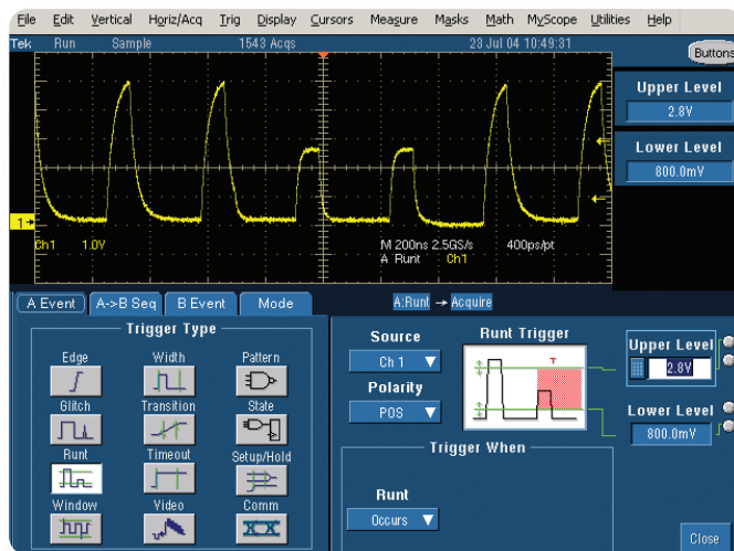
► 图 2. 大量高级的示波器触发提高了更加简便快速地捕获不同类型信号的效率。
