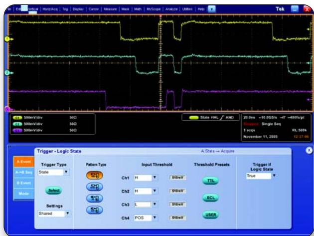
► 图9. DPO画面显示了对一个器件的时间判定的码型触发。在通道1和通道2上的信号变成高时，通道3的输入线应该为高。把通道3设为低状态，揭示了附加延迟问题。
