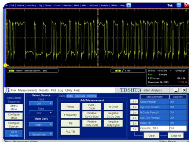
▶ 图 16. 当 DPO7000 在复杂的信号上运行 TDSIT3 程序时,可以迅速进行完善的抖动分析测量,以便设计工程师分析抖动。
