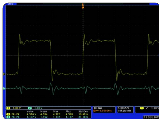
► 图 2. 在通道 1 上开关输出导致的地面反弹。
