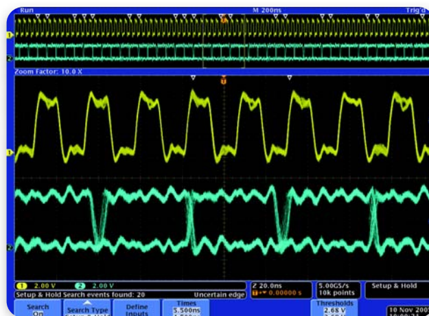
► 图4. DPO4000 把搜索和标记功能与专用建立时间和保持时间触发结合在一起。在这个画面顶部, 白色空三角号标记着所有建立时间和保持时间超限, 用户定义的建立时间和保持时间分别是 5.5ns 和 4.5ns。
