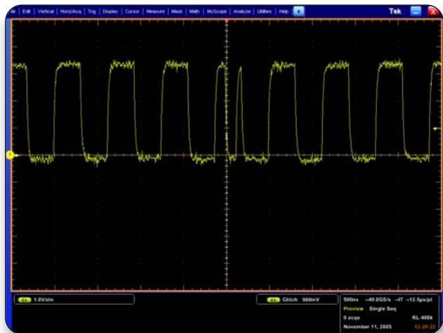
► 图 14. 通过 DPO7000 毛刺触发功能，在 D 型触发装置的 Q 输出上捕获了一个不频繁的亚稳定状态。
