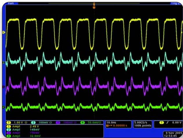
► 图 3. 使用 DPO4000 1 GHz 带宽示波器上的边沿触发捕获的串扰实例。其中一条并行 50 欧姆轨迹(通道 1)上的快速脉冲生成了高能辐射。这些入侵者可能会感应到附近的走线中。在距入侵者最近的通道 2 和通道 3 中可以明确看到这一点。随着距入侵者走线的距离提高,串扰会下降。通道 4 上 32 mV 的幅度表明了这一点,这是距入侵者最远的平行的受害者轨迹。
