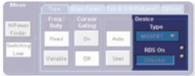
▶ 그림 4. 사용자가 데이터 시트의 R_{DSon} 또는 V_{CEsat} 값을 입력할 수 있는 TDSPWR3 입력 페이지
