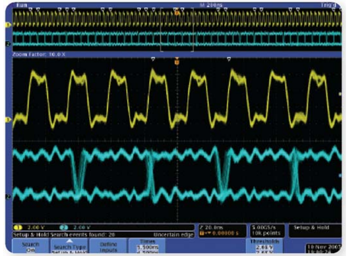
▶ 그림 4. DPO4000은 검색 및 표시 기능에 특수 셋업 및 홀드 트리거링 기능이 결합되어 있습니다. 이 디스플레이 상단에서 흰색 빈 삼각형은 사용자 정의된 셋업 및 홀드 시간이 각각 5.5ns 및 4.5ns일 때 모든 셋업 및 홀드 위반을 표시합니다.
