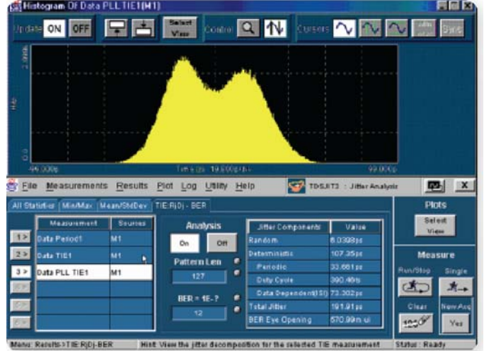
▶ 그림 17. TDSJIT3 지터 분석 애플리케이션이 포함된 DPO7000은 데이터 신호상의 총 지터가 다음 값과 동일함을 보여주고 있습니다. 즉, \sim 192 \text{ ps} (T_j = D_j + 2Q(\text{BER}) * R_j) , 여기서 Q(10E-12) = 7 . 데이터 PLL TIE 측정의 관련 히스토그램은 엔지니어에게 데이터 신호 통계 분포의 그래픽화된 표시를 제공합니다.
