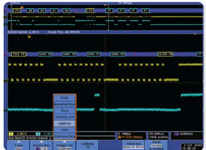
▶ 그림 8. DPO4000 I 2 C 버스는 읽기 또는 쓰기에 대해 선택된 주소 76을 트리거링합니다. 각 패킷은 핸드 디코딩을 제거하고 오류를 줄이며 시간을 절약하여 쉽게 디코딩됩니다.
