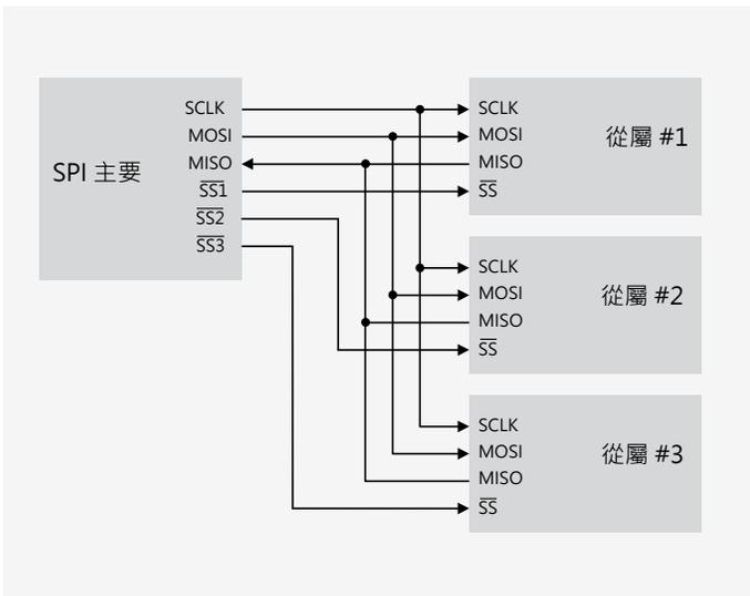
SPI 不會針對匯流排上每個裝置使用獨特的位址，而是使用 SS 行來指定哪個裝置資料正在傳輸至/自哪個裝置。因此，匯流排上的每個獨特裝置均需從主裝置取得自己的 SS 訊號。如果有 3 個從屬裝置，主裝置就會送出 3 個 SS 訊號，每個從屬裝置一個。
