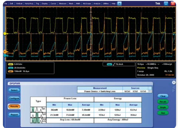
► 圖5 交換式裝置負載變化時的最小、最大及平均功率損耗
