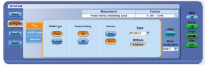
► 圖 4. DPOPWR 輸入頁，可讓使用者輸入 RDS_{ON} 和 VCE_{sat} 的資料表單值。
