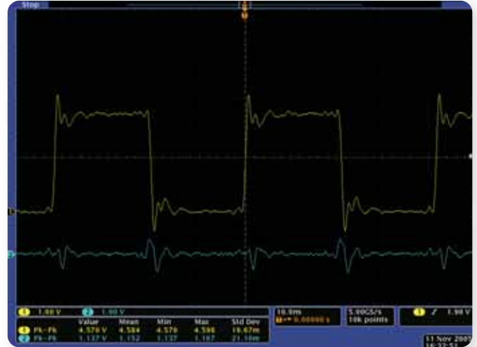
▶ 圖 2. 通道 1 上切換輸出所產生的接地雜訊。
