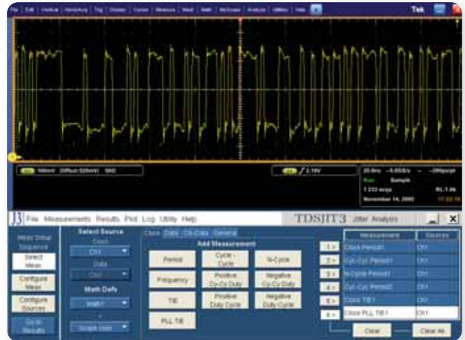
▶ 圖 16. 當 DPO7000 在複雜訊號上執行 TDSJIT3 應用程式時，可使用精密的抖動分析量測，讓設計工程師能夠快速進行分析。
