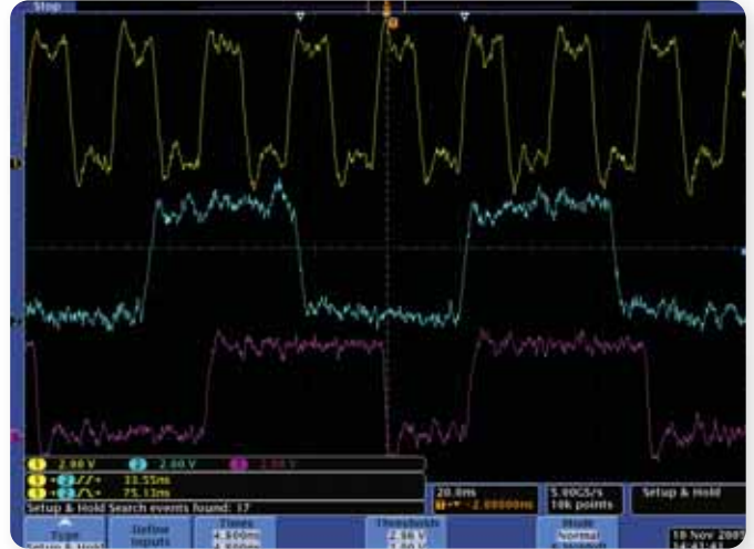
▶ 圖 10. 使用 DPO4000 設定與保持觸發以及搜尋/標記功能會顯示螢幕上方由白色三角形所標示的介穩狀態。通道 1 是時脈訊號，而通道 2 是資料訊號，通道 3 是 D 型正反器鎖存的介穩態 Q 輸出。
