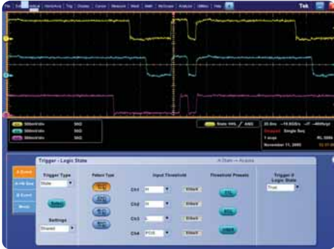
▶ 圖 9. DPO 顯示器可顯示裝置的時間條件樣式觸發。當通道 1 和通道 2 的訊號上升到高狀態 (high) 時，通道 3 的輸入端應該為高狀態 (high)。設定通道 3 為低狀態 (low) 可發現額外的延遲問題。
