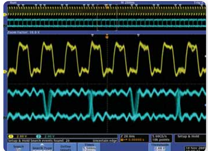
▶ 圖 4. DPO4000 結合了搜尋與標記功能和專門的設定與保持觸發。在本畫面的頂端，白色空心三角形依據使用者將設定與保持時間分別定為 5.5ns 和 4.5ns 的設定，標出所有的設定與保持違反。
