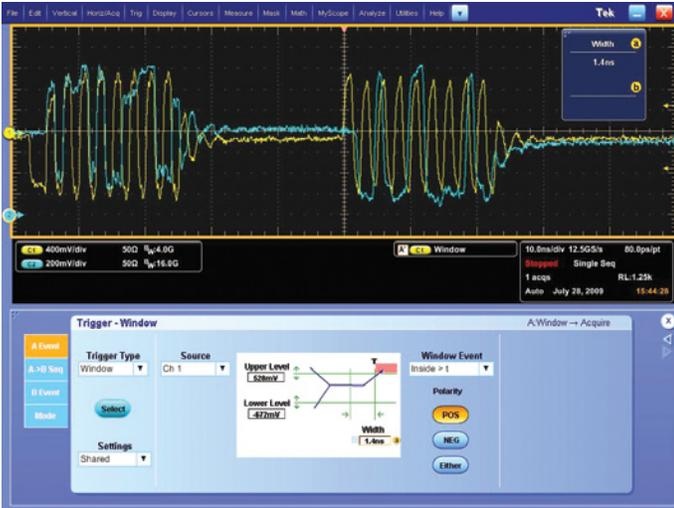
Figure 9. Using « Window » trigger to identify DQS Write Preamble.
