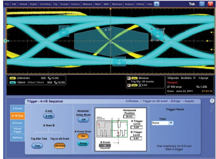
Figure 10. Visual trigger on a DQ Signal Eye.
