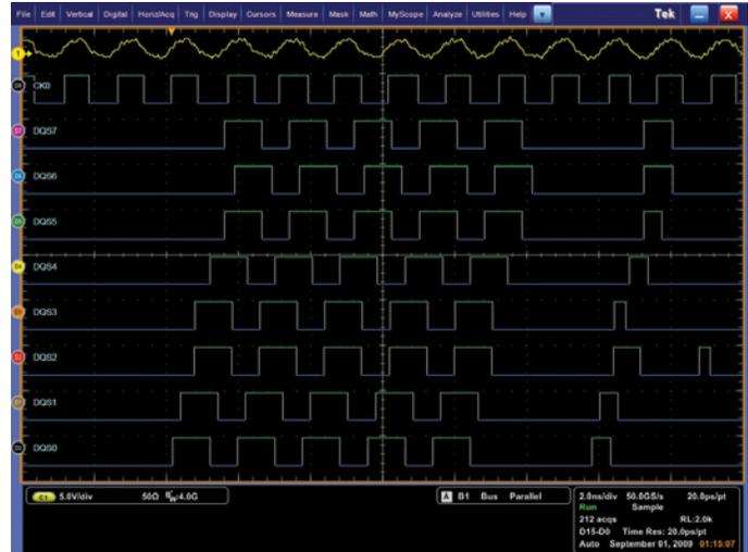
Figure 22. DQS0 – DQS7 skew relative clock during write leveling operation.
