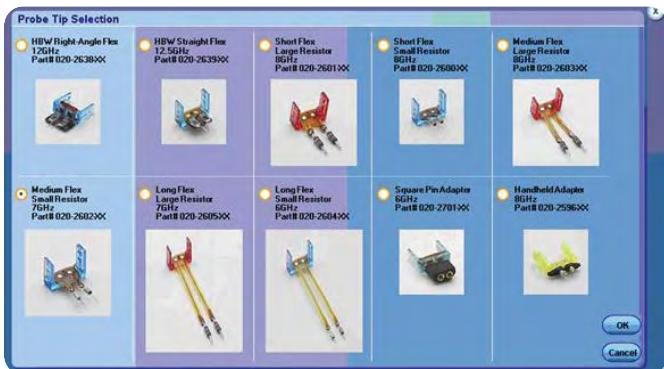
► **Figure 9.** Tektronix P7380/80A ProbeTip Selection Menu.
