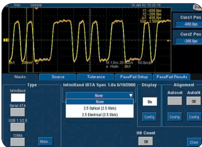
▶ 図6. コンプライアンス・ジッタ・テスト・パターンは、ジッタ解析用信号です。この画面には、前のセクションで説明されたジッタの分離結果が表示されています。
