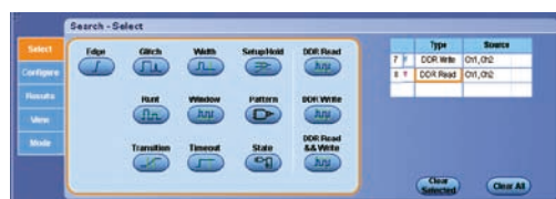
図25. Pinpointトリガのトリガ・タイプ設定
