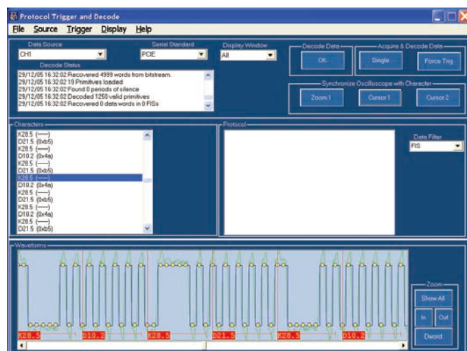
図19. プロトコル・トリガとデコード
