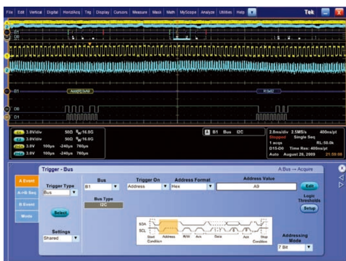
図15. ロー・スピード・シリアル・プロトコル・トリガ
