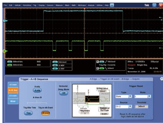
図9. ドライブの欠陥でトリガ
