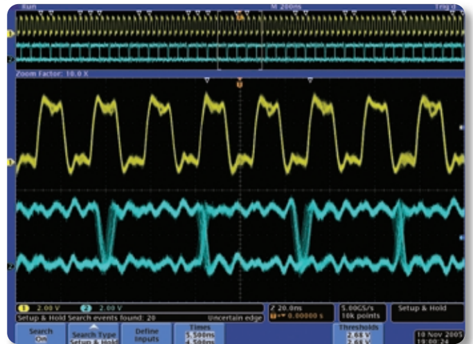
▶ 図4: DPO4000シリーズには、セットアップ/ホールド時間違反でトリガおよびサーチ、マークする機能があります。画面上部にある白抜き三角矢印は、ユーザ定義されたセットアップ時間5.5ns、ホールド時間4.5nsに違反した箇所すべてにマークされています。
