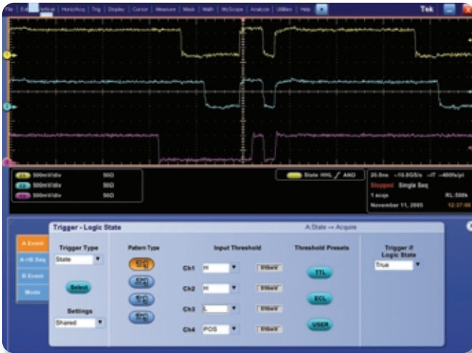
▶ 図9：デバイスにおいて、時間で指定したパターンでトリガした例。Ch1とCh2がハイになるとCh3の入力ラインはハイになります。Ch3をローに設定することで、遅延による問題を解決することができます。
