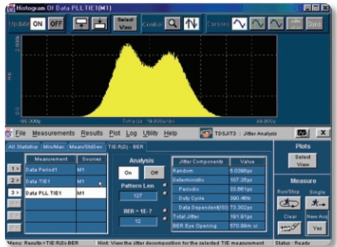
▶ 図17：DPO7000シリーズで実行されたTDSJIT3ジッタ解析ソフトウェアの例。トータル・ジッタは192ps ( T_j = D_j + 2Q (BER) \times R_j ) *、ここで Q (10E-12) = 7 。PLL のTIE測定では、データ信号の標準偏差がグラフで表示されます。 *ジッタ・モデルがDual-Diracの場合。
