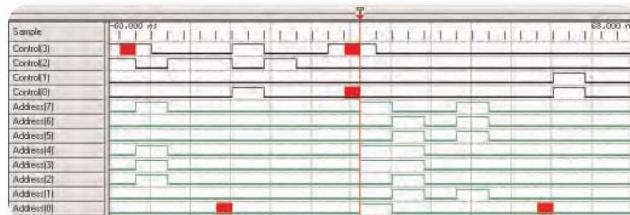
► 图 2. 扩展后的 4 位控制总线和 8 位地址总线，在单个信号上显示红色毛刺标记。
