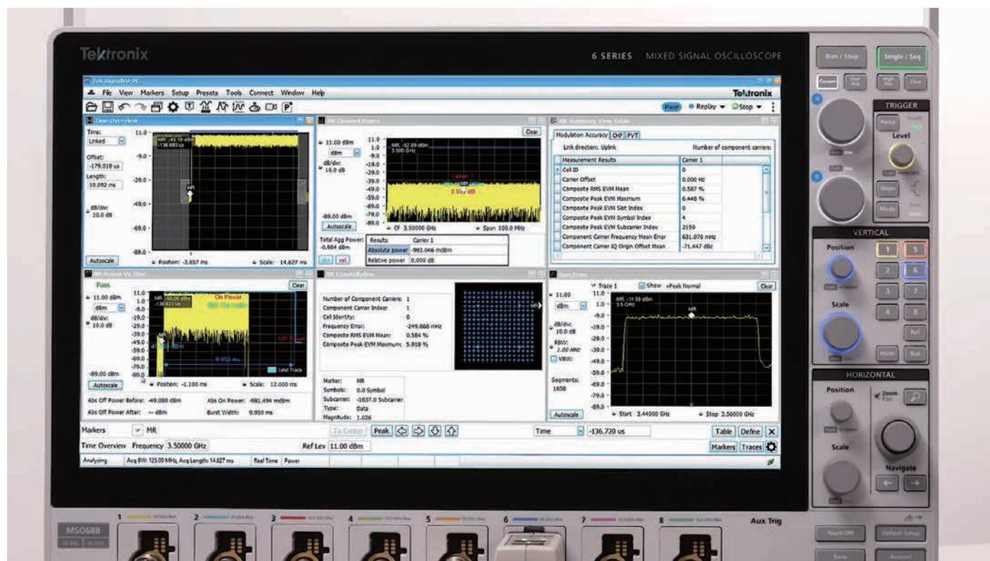
図3. この測定では、コンスタレーション・ダイアグラムで表示されているEVMは期待通りになっている
