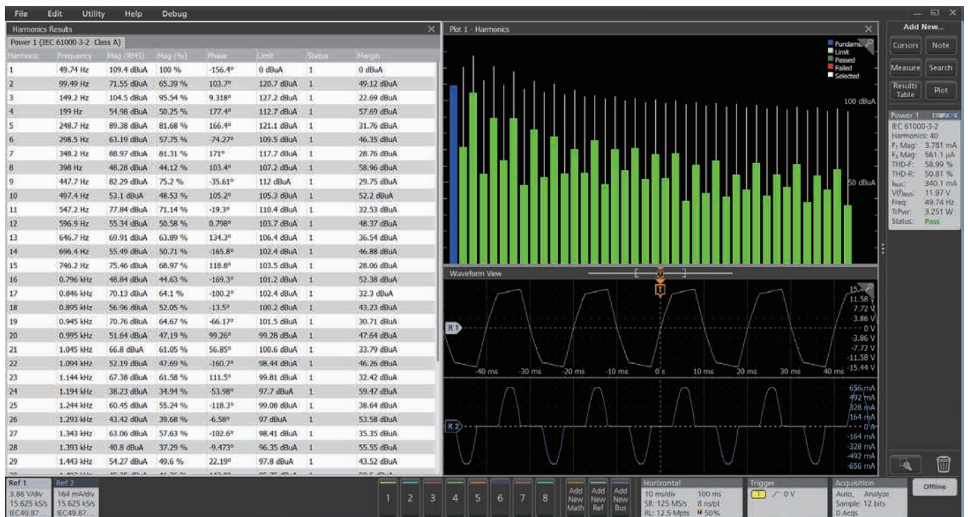
図11. 5-PWRによる高調波の測定結果の例。正弦波でない電流波形が右下に表示されている。高調波バーにより高調波成分がデシベルのスケールで表示されている。奇数次の高調波が大きくになっているが、IEC 61000-3-2のリミット内に十分に入っている。
