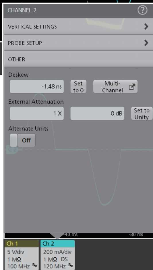
図2. 調整後の静的スキュー補正。このプローブに保存されている伝搬遅延データをもとに、-1.48nsのデスクューが加えられている。
