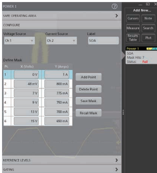
図7. SOA マスク・エディタ・ウィンドウ。マスクは、スイッチング・デバイスのデータ・シートまたはユーザー定義のセット(電圧、電流)によって定義する。
