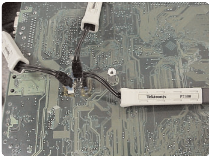
► 图 3. 三个带焊接 Tip-Clip™ 部件探测电路板的 P7380 差分探头。
