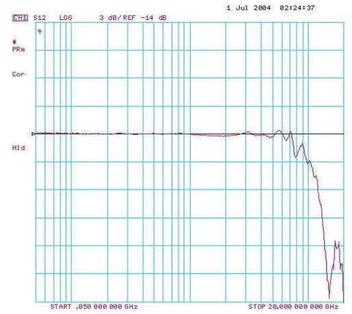
▶ 그림 7. Tektronix P7380 프로브 응답
