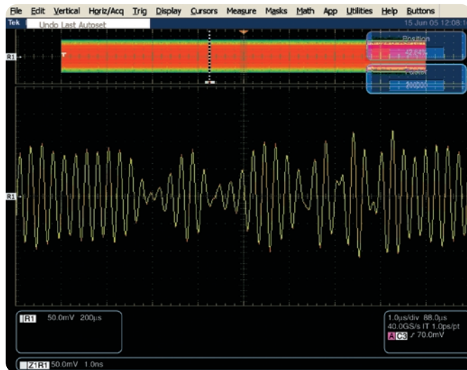
▶ 図4：TDS6154C型で観測した、DS-UWB送信信号の電圧対時間表示。ローワ・バンドのウェーブレットが観測できます。アッパー・バンドのウェーブレットは、ローワ・バンドの周波数の約2倍です。
