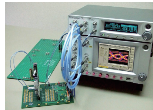
使用BERTScop进行接收机容限压力测试
