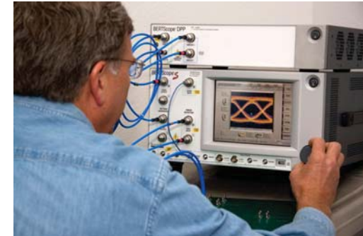
DPP125 – 正在对12.5 GB/s信号进行4阶均衡处理
