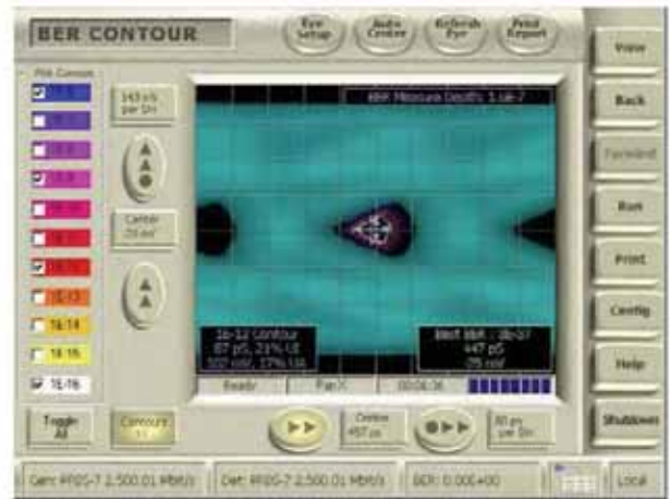
图 16. 全面成形的受压眼图的眼图 (左) 和 BER 轮廓 (右), 其中包含 ISI 滤波器 (长电缆)、正弦曲线抖动、随机性抖动和正弦曲线噪声 (提供垂直闭上)。这个实例表示一台典型接收机, 难度相当大。
