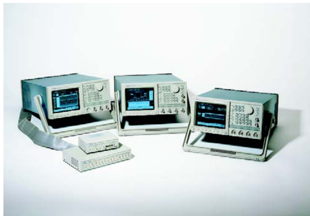
图 47. DG2020A 码型发生器使用外部信号接口“适配夹”。
