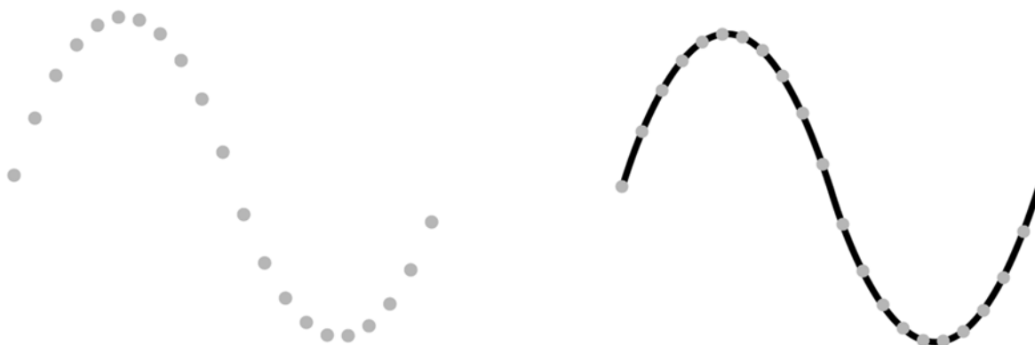
图 17. (左)表示正弦波的一串样点；(右)重建的正弦波。
