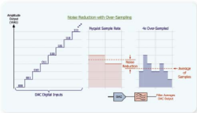
图 20. 以高于奈奎斯特率许多倍来对信号过取样，可以使数模转换器之后的滤波器更加精确而平均地输出噪声电平，减小量化噪声。
