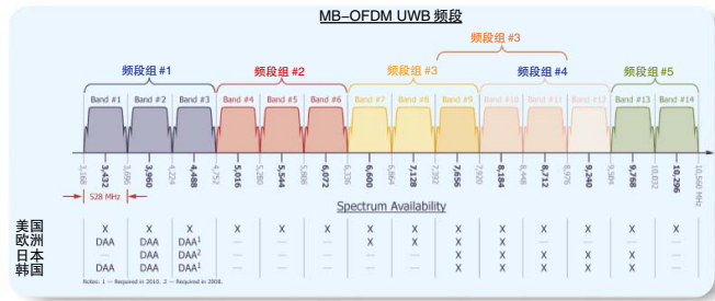
► 图 15. WiMedia 频段组结构为其 MB-OFDM 信号结构提供了多个频段组。并不是所有频段都能在全球范围内使用，有些频段要求 DAA 来减轻干扰。
