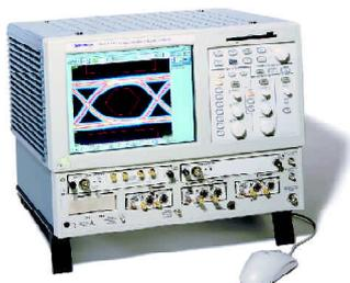
CSA8000通信信号分析仪是为高性能通信应用专门设计的，为数据通信和电信器件、收发器组件和传输系统的设计评估和生产测试提供了理想的工具。
