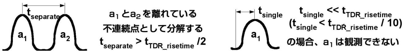
▶ 図 7. TDR 分解能の経験則：2つの不連続点を別のもので認識するためには、測定システムの立上り時間は2点間の距離の1/2以下でなければならない。
