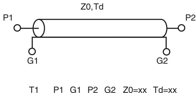
▶ 図 25. SPICE 回路の表示と、損失のない伝送線路・ラインのネット・リスト・ライン・モデルシングルエンド構成では、ノード G1 と G2 は接地されます。
